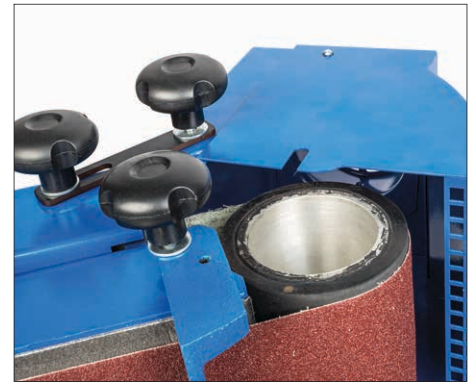
Um Radien zu schleifen, kann die rechte Abdeckung geöffnet und ein Zusatztisch angebracht werden
