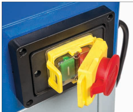
Die Maschine wird mit einem klassischen Ein-/Ausschalter mit Notaus-Funktion gestartet
