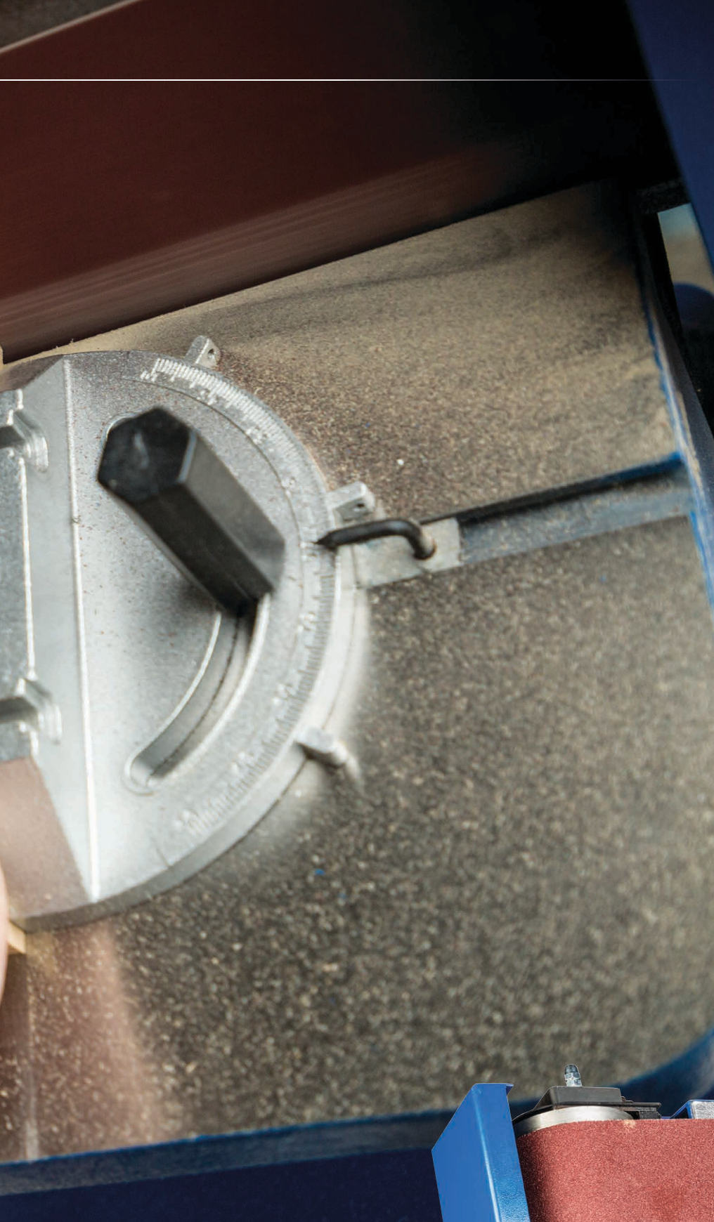
Da die Skala recht grob eingeteilt ist, sollte immer ein Probeschleif durchgeführt werden
