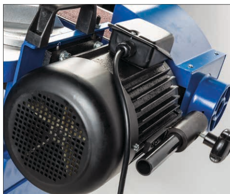
Der Drehstrommotor hat eine Aufnahmeleistung von 2,2 kW
