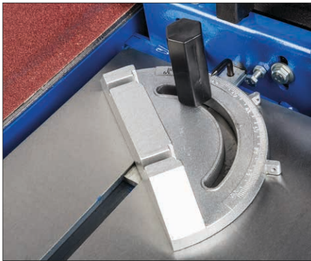
Der winkelskalierbare Schiebeanschlag gehört zum Lieferumfang
